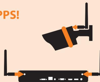
Verwenden Sie die kleinen Antennen an Kamera und Receiver, wenn der Abstand zwischen den beiden klein ist.
