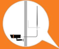
Pour de plus longues distances entre la caméra et le routeur, il existe des câbles d'antenne et des antennes (vendus séparément) qui peuvent être montés à l'extérieur des murs pour obtenir une portée maximale.
